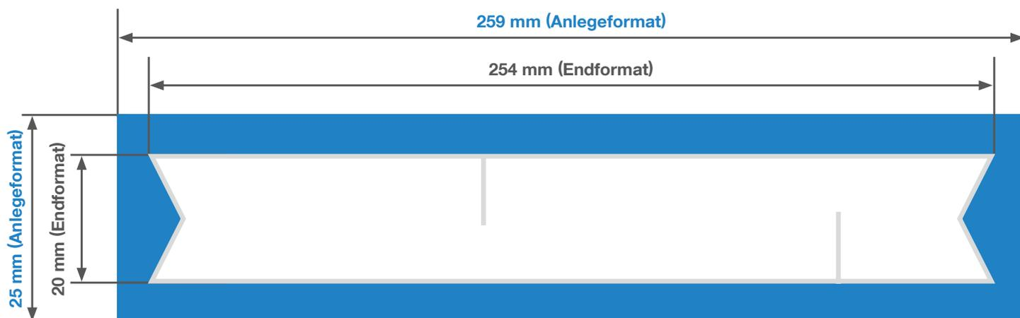
**Anlegeformat:** 259 mm x 25 mm    **Endformat:** 254 mm x 20 mm
